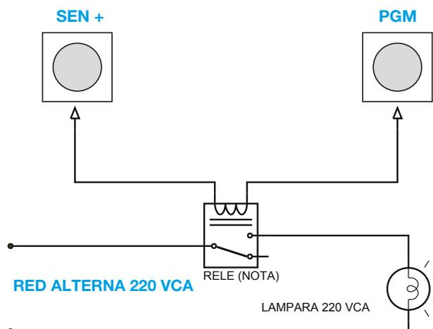
*Nota: La bobina del rele debe ser de 12VCC mientras que su salida debe poder manejar 220VCA con la corriente requerida por la carga.*
